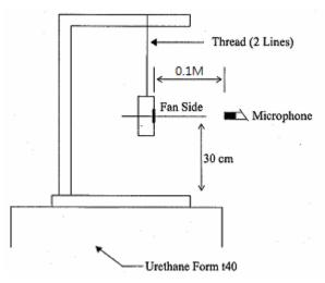
0.1 METER FROM MICROPHONE TO FAN INTAKE
