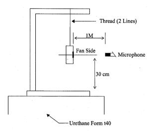
1 METER FROM MICROPHONE TO FAN INTAKE
